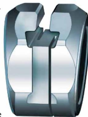
*Применение в конструкции клина поперечных разрезов увеличивает гибкость детали, обеспечивая лучшую герметичность*
