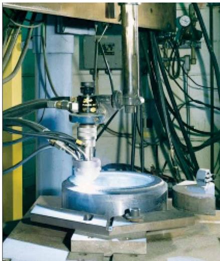
*Автоматизированная операция нанесения наплавки на уплотнительную поверхность клина задвижки*
