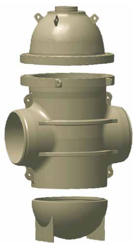
Рис. 1. Детали «Задвижки шиберной» DN 1000 PN 8,0 для магистральных нефтепроводов ОАО «Транснефть»: 1 — корпус; 2 — днище; 3 — крышка.
